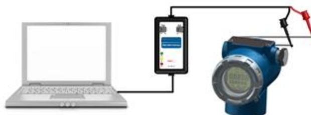
Conexão da interface alimentando o equipamento
