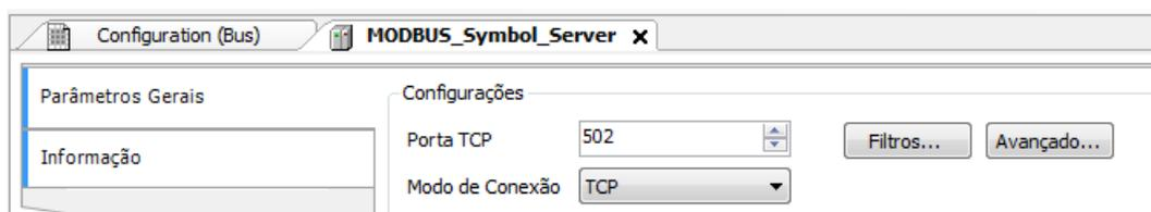
Figura 96: Tela de Configuração Parâmetros Gerais MODBUS Servidor
