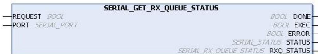
Figura 165: Bloco para Visualizar o Status da Fila RX
