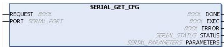
Figura 163: Bloco para Capturar a Configuração da Serial
