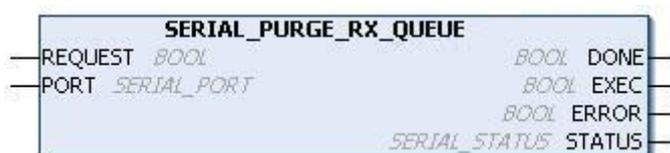
Figura 166: Bloco para Limpar a Fila RX
