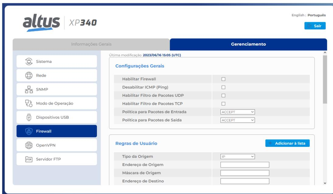
Figura 180: Tela de Configuração do Firewall
