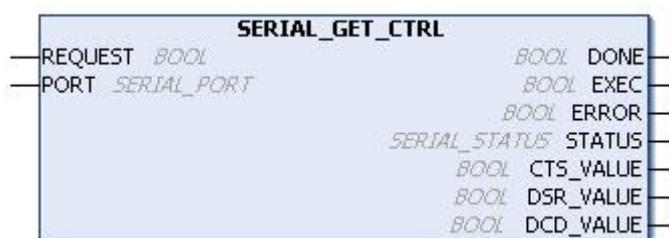
Figura 164: Bloco para Visualizar os Sinais de Controle
