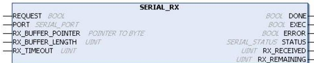
Figura 167: Bloco para Ler Valores do Buffer de Recepção
