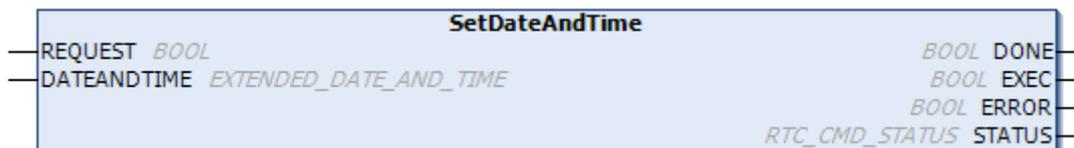
Figura 158: Ajuste de Data e Hora em Milissegundos
