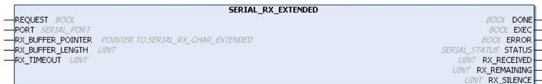
Figura 168: Bloco para Leitura do Buffer de Recepção
