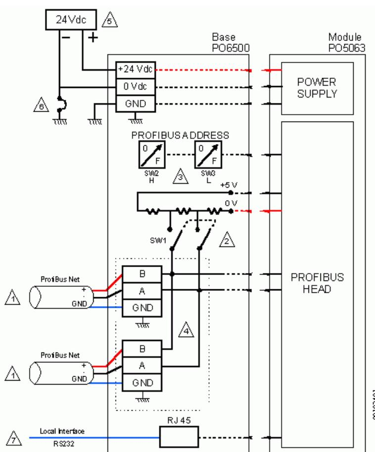
**Figura 3-2 Diagrama de Ligação Utilizando a Base PO6500**
