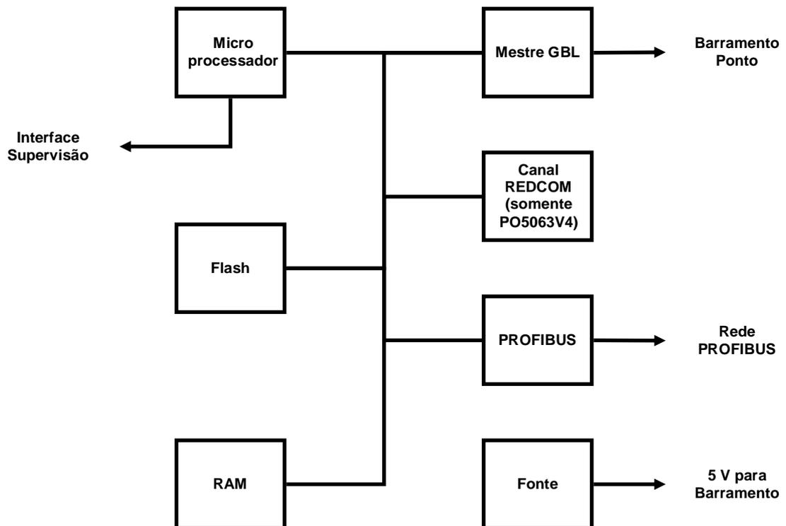
Figura 2-4 Diagrama de Blocos da PO5063 e PO5063V4
