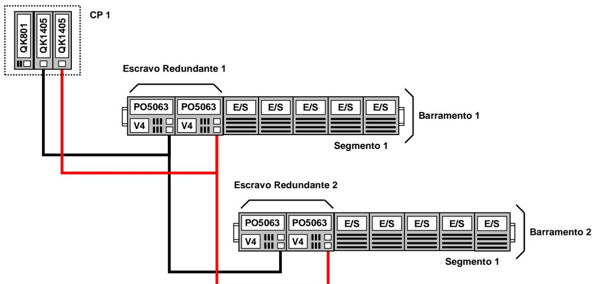
**Figura 12-5 Sistema Redundante de Meio Físico e Mestre utilizando QK1405**
