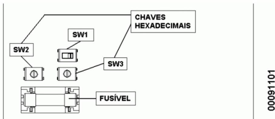
**Figura 3-4 Chaves de Terminação (SW1) e Endereço (SW2 e SW3) da Base PO6500**
