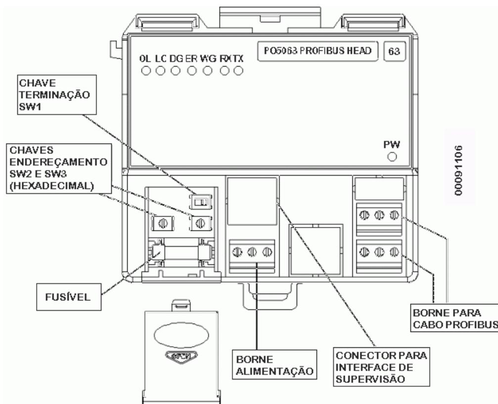
Figura 2-2 Conexões da Cabeça PO5063 na Base PO6500
