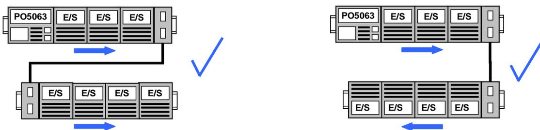
Figura 4-5 Disposições Corretas dos Módulos Utilizando PO5063
