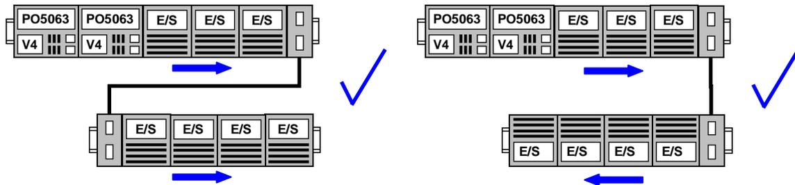
Figura 4-7 Disposições Corretas dos Módulos Utilizando PO5063V4
