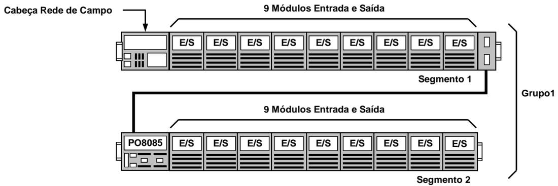
**Figura 4-1 Exemplo 1 Utilizando Dois Segmentos**
