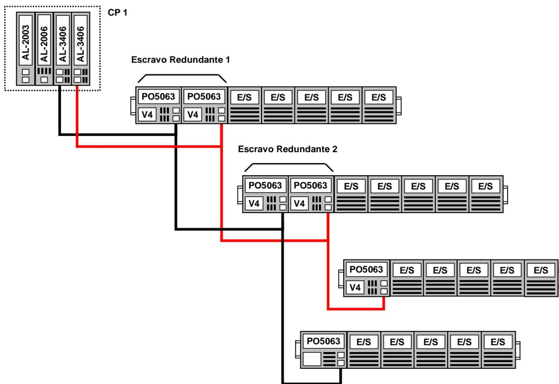
**Figura 12-6 Sistema Híbrido Redundante de Meio Físico e Mestre utilizando AL-3406**
