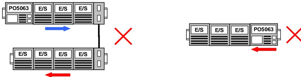
Figura 4-6 Disposições Incorretas dos Módulos Utilizando PO5063
